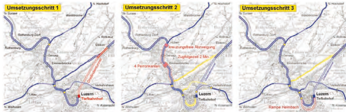
Abb 10: Optimierung des Schienennetzes im Raum Luzern: Umsetzungsschritte 1 bis 3 rot: Infrastrukturgänzungen gemäss Umsetzungsschritte 1 bis 3; gelb: Anpassungen oder Aufhebungen Infrastruktur zwischen Umsetzungsschritten 1 bis 5 (Quelle: Rahmenplan SBB)
